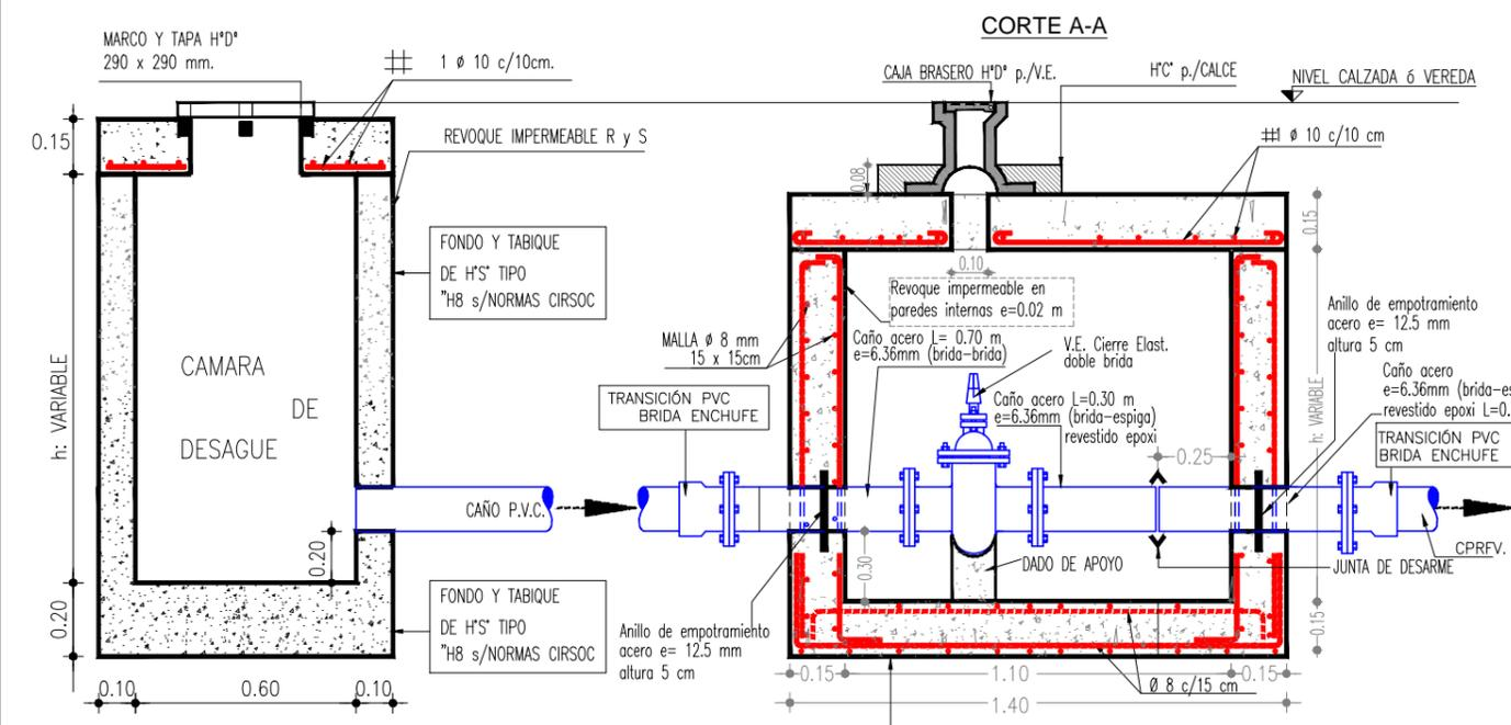
Reforzamiento de hormigón armado H-1, H-17 armadura 420 en ambos sentidos (ortogonal) y en ambas caras de tabiques y losas (Ø8 cada 15 cm.)
